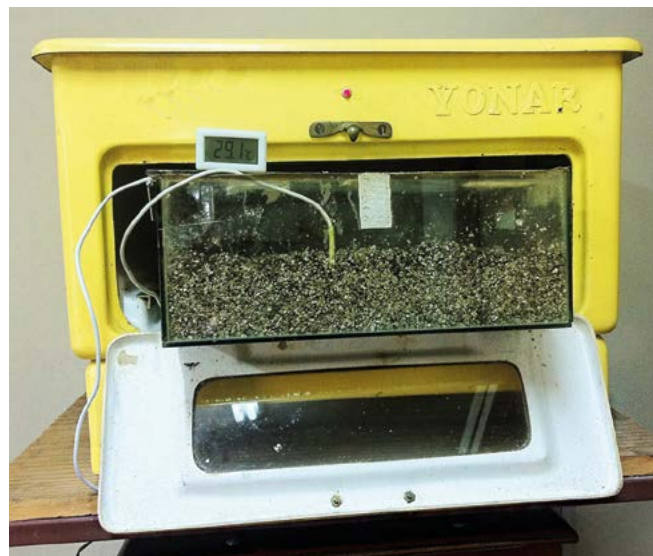
Fig. 44. Incubación de los huevos en estufa. Para un registro más preciso de las temperaturas, los sensores de temperatura se insertan directamente en el sustrato de vermiculita.
